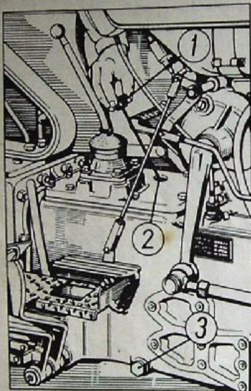
Rys. 24. Smarowanie mechanizmów przekładni i podnośnika hydraulicznego: 1 — korek ze wskaźnikiem płetwowym, 2 — otwór wlewowy oleju, 3 — korek spustowy oleju.
