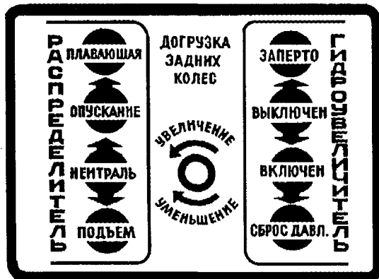
Рис. 7.10. Схема управления гидросистемой тракторов МТЗ-80, МТЗ-80Л, МТЗ-82, МТЗ-82Л
